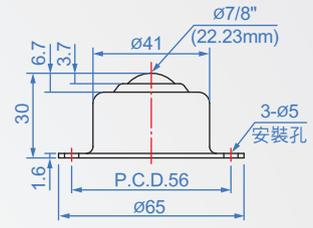
此系列為向上使用，下法蘭安裝孔固定型，强度高，安裝時按照底座安裝孔位置鑽孔即可。鋼製主珠及輔助珠材質為SUJ2，不鏽鋼製主珠及輔助珠材質為SUS440C。
